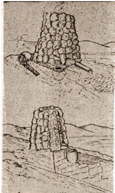
Медеплавильные печи раннего железного века по данным раскопок на горе Думной. (Реконструкция Е. М. Берс.)
